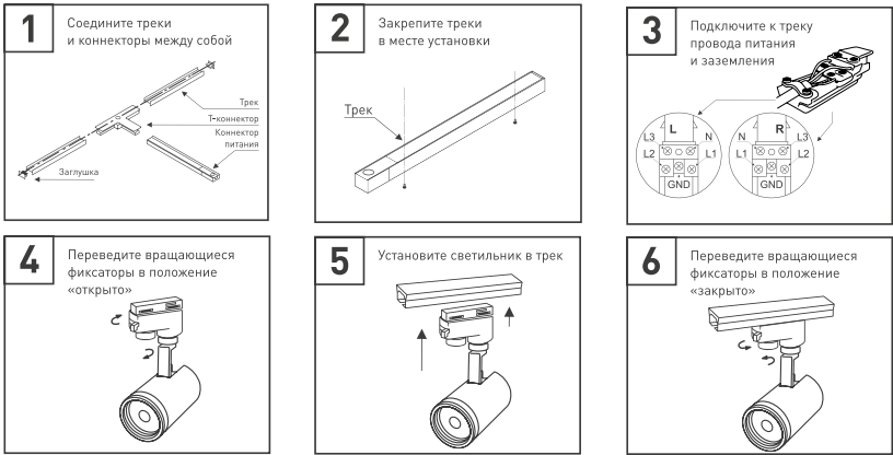
Рис. 2. Установка и подключение светильника
