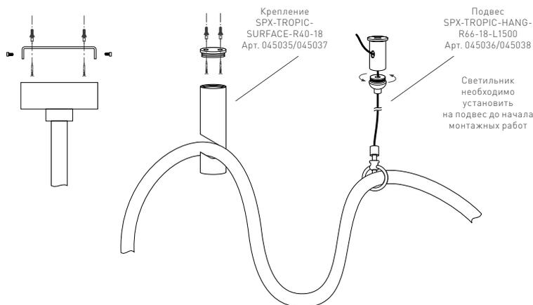
Рис. 2. Установка светильника
