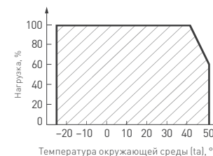
Рис. 3. Максимальная допустимая нагрузка, % от мощности источника
